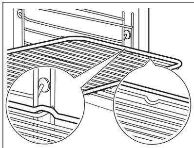
Schieben Sie den Rost mit den Füßen nach unten zwischen die Führungsstäbe der Einhängegitter. Stellen Sie sicher, dass der Rost die Rückseite des Garraums berührt.
