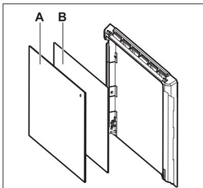
Achten Sie darauf, dass Sie die mittlere Glasscheibe korrekt in der Aufnahme installieren.
