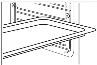
Schieben Sie das Backblech zwischen die Führungsstäbe der Einhängegitter. Platzieren Sie das Backblech mit Gefälle zur Rückseite des Backofeninnenraums.
